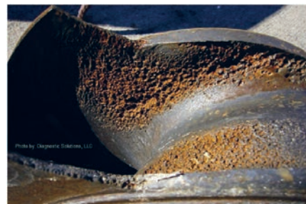
Fig. 5.10. Cavitation damage on an impeller
